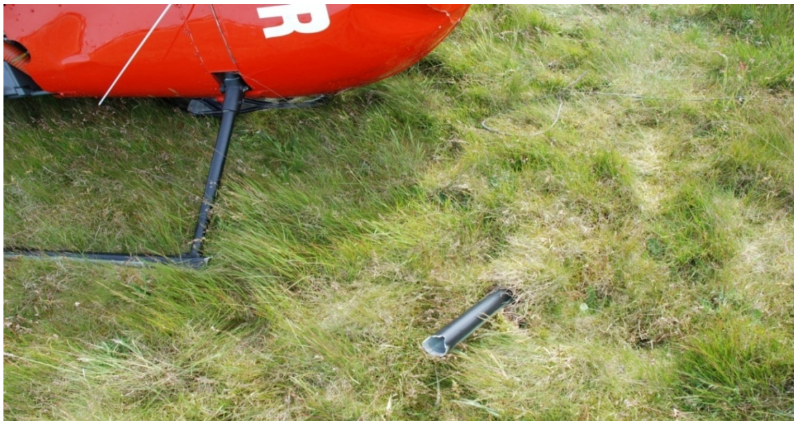
Figuur 3: linkerslede van het onderstel; diep in de grond gestoken en afgebroken
