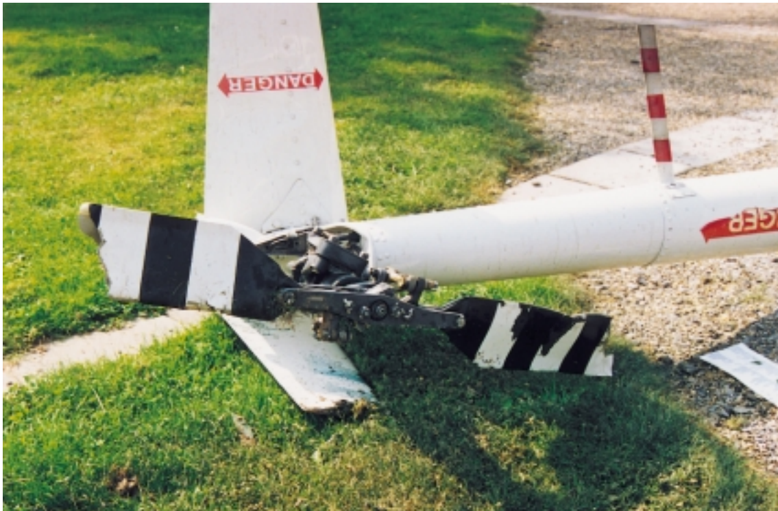
Schade aan staartrotor
